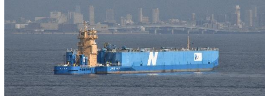
大阪港の外に停泊していた JFE の鋼材運搬バージです。プッシャーの接続具合がよくわかります。
